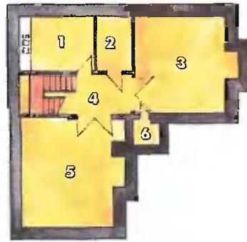
План подвального этажа: 1 — хозяйственное помещение; 2, 6 — кладовки; 3 — спальня; 4 — холл; 5 — помещение для активного отдыха
