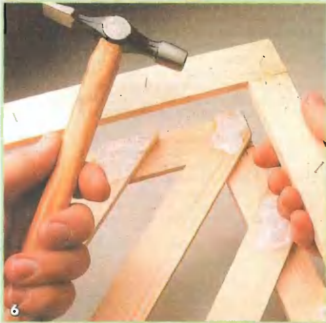
Рамы склеивают, а затем соединения усиливают штифтами
