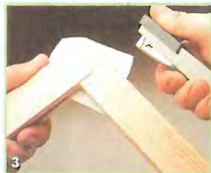
3 Клеевые соединения усиливают скобками с помощью степлера
