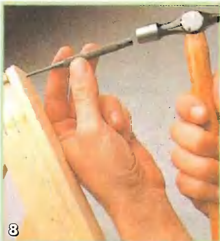
Штифты заглубляют в древесину бордком. Лунки поверх головок зашпаклевывают
