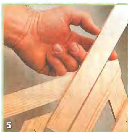
5 Разметку шага между вкладышами можно сделать с помощью обрезка рейки
