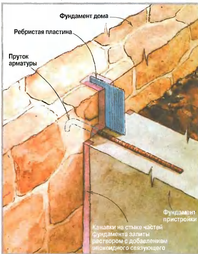
Водонепроницаемый стык между частями фундамента. Ребристая пластина из поливинилхлорида перекрывает стык между старым и новым фундаментом. Для ее установки пришлось выдолбить пазы глубиной 100 мм, в которые были вмурованы пластины. С помощью брусков, прибитых к внутренней стороне щитов опалубки, на стыке частей фундамента образованы канавки, которые впоследствии заполнили раствором с добавлением эпоксидного связующего. Через такой «замок» влага не пройдет
